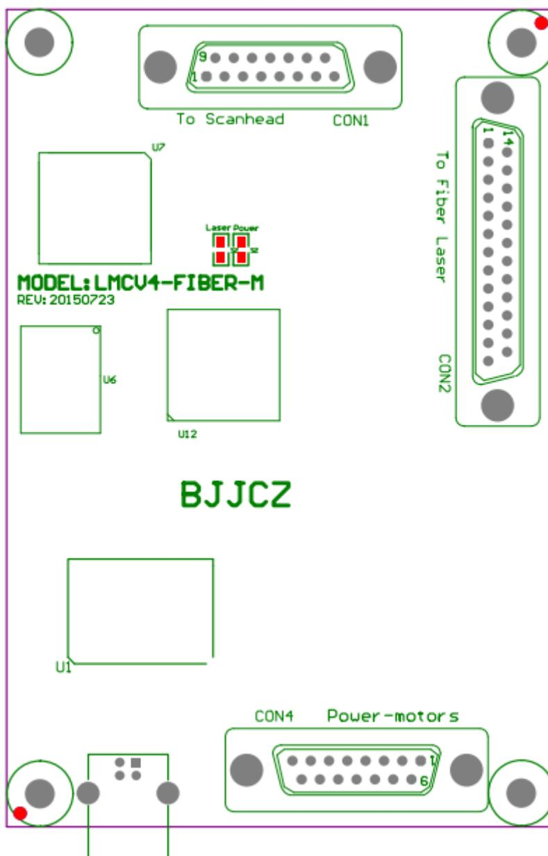
图 1-1 LMC2015 Fiber-M 控制卡示意图
