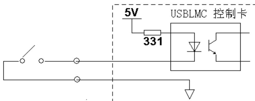
图 2-8 通用输入信号 (/XORG0/GIN15 /Remark) 推荐的连接方案
