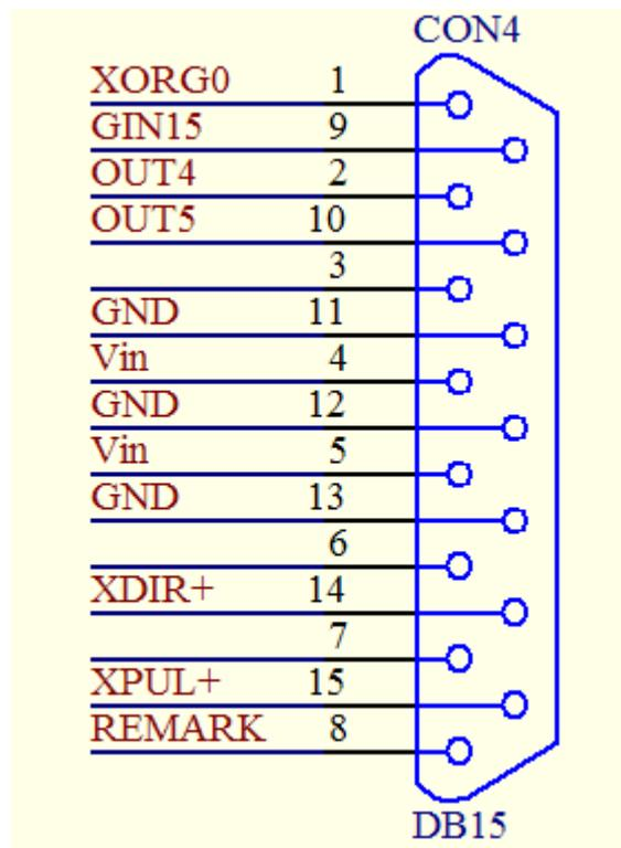
图 2-4 CON4 插座管脚定义示意图
